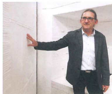
Martin Sembach führt das Unternehmen in vierter Generation. Hier zeigt er einen der Kammeröfen, der mit Aluminiumoxidfasern isoliert ist
