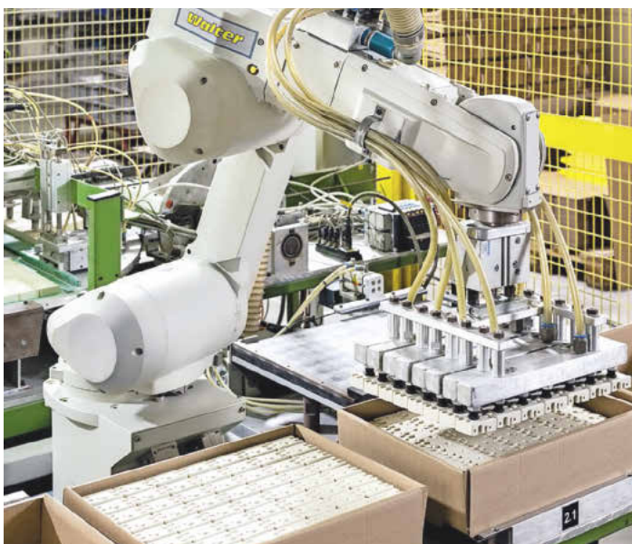
Von Hand zu umständlich: Roboter „Walter“ schichtet gleich 56 Temperaturbegrenzer für Glaskeramikherde auf einmal in die Verpackung.
